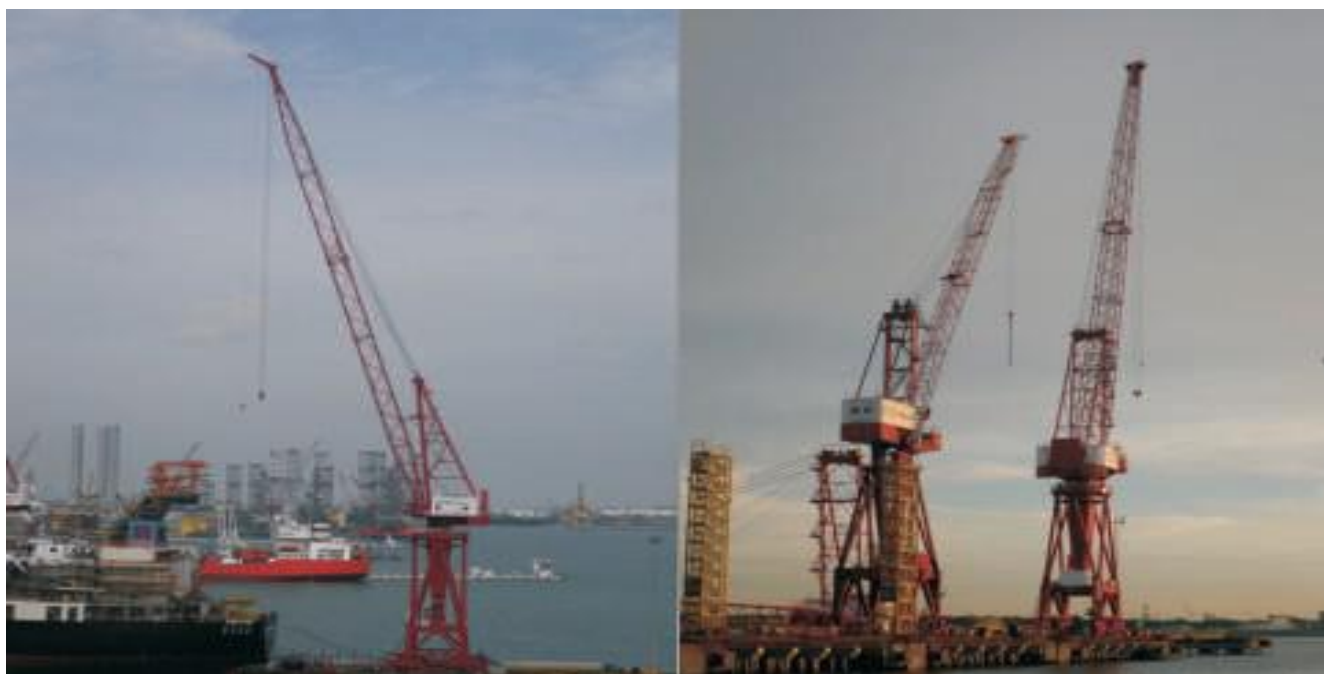
江苏江南起重机械有限公司为新加坡吉宝船厂设计制造的30t*105m门座机 30t*105m level luffing crane Customer: Keppel shipyard(Singapore)
