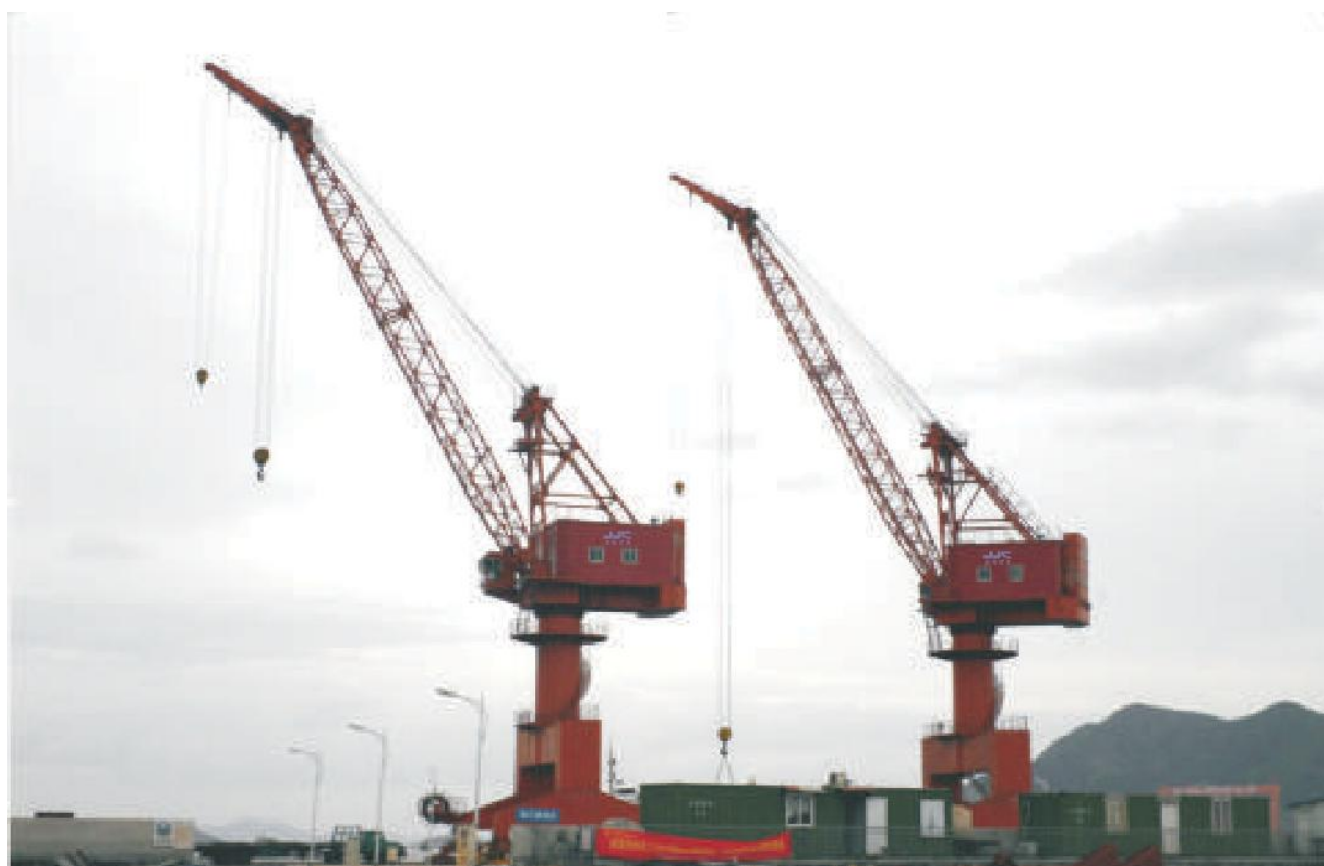
江苏江南起重机械有限公司为中基船业设计制造的45t*70m 门座机 45t*70m level luffing crane Customer: ZHONGJI Shipyard
